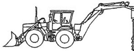
Esempio di terna con trivella
