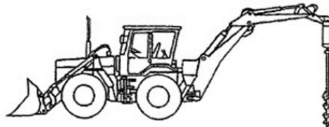
Esempio di terna con trivella
